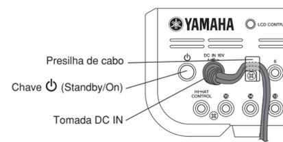
2. Use as fitas de cabo para amarrar os cabos ao rack, como mostrado à direita. Se necessário, use o tubo espiral.
