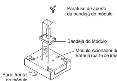
2. Encaixe a bandeja do módulo na garra do suporte, apertando a maçaneta para fixar a posição.
