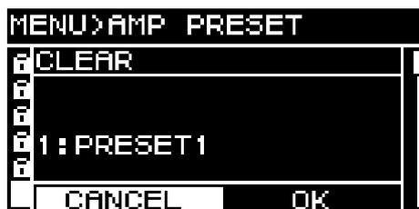
Não é possível apagar uma predefinição protegida do amplificador.
