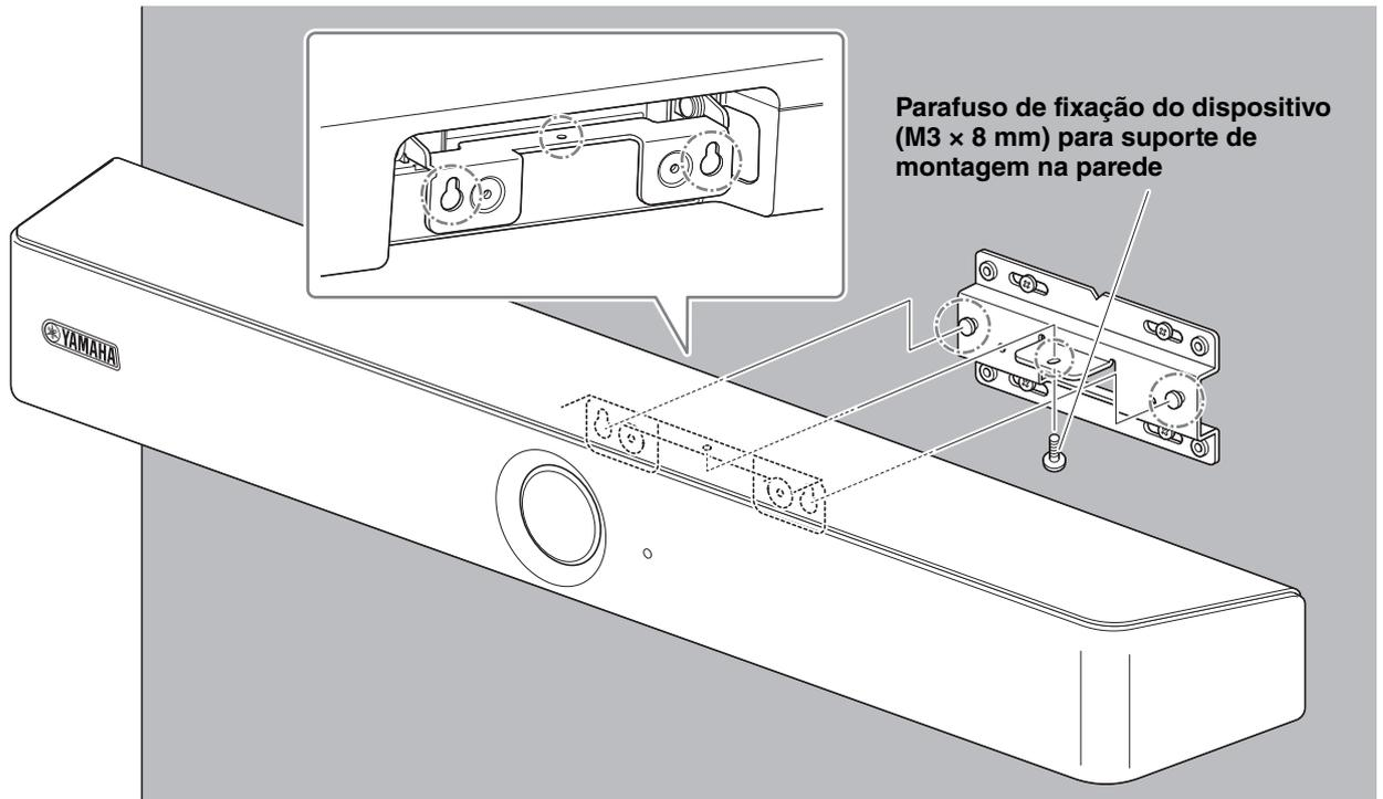
**3. Na parte inferior do suporte de montagem na parede, prenda o dispositivo usando o parafuso de fixação do dispositivo incluído (M3 x 8 mm) para o suporte de montagem na parede.**
