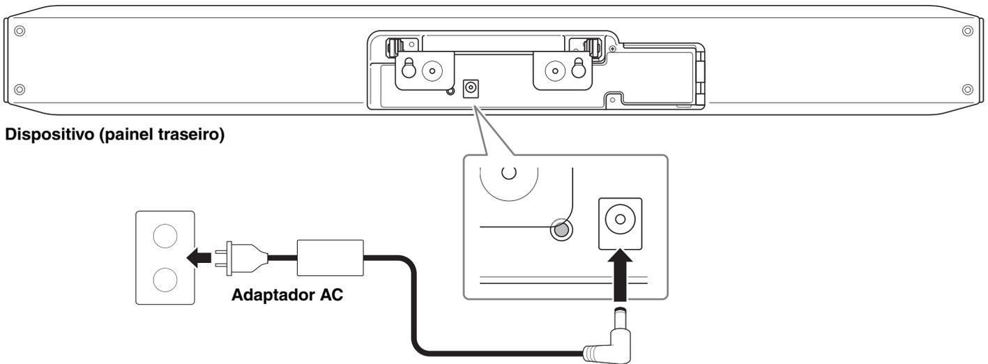
A conexão do adaptador CA liga automaticamente o dispositivo.
