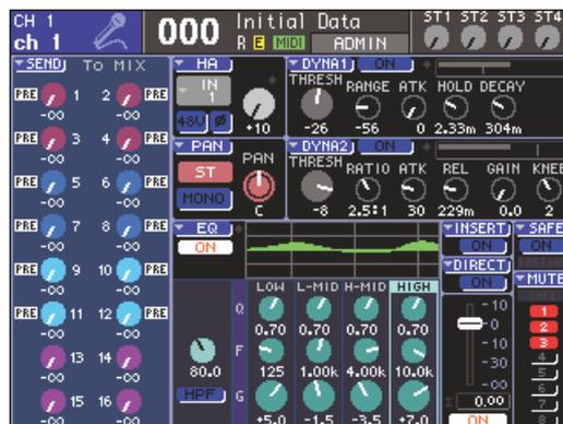
Use a seção DISPLAY ACCESS (→ p. 19) para selecionar a janela que deseja visualizar. Em seguida, use as teclas de cursor da seção de entrada de dados (→p. 22) para mover o cursor ao parâmetro desejado, e use o dial ou as teclas [INC][DEC] para editar o valor.
