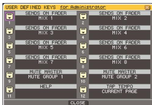
As doze teclas no quadro correspondem às teclas do usuário [1]–[12] do painel da console, e a função ou parâmetro associado a cada uma é mostrado à direita da tecla correspondente. Se a tecla não tiver nada associado à ela, é mostrada a indicação “----”.
