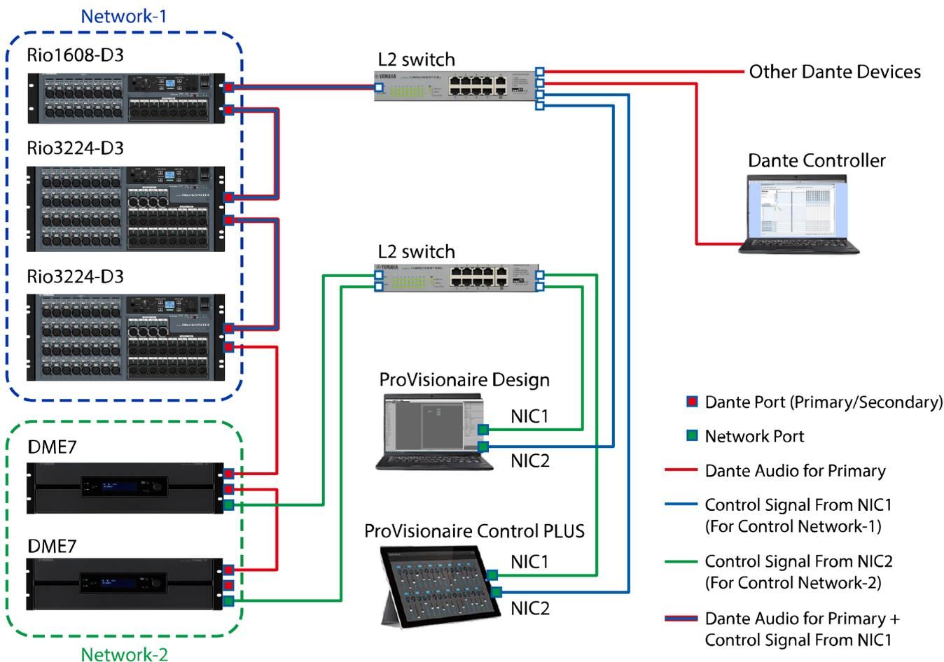
A configuração de latência apropriada para sinais enviados e recebidos por uma rede de áudio Dante difere dependendo do método de conexão e da escala. A seguir está uma explicação de como selecionar a configuração [Latency] com base nas conexões entre os dispositivos compatíveis com Dante e o DME7.
