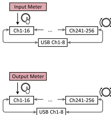
1. Com a tela [Menu] exibida, gire o botão giratório principal para selecionar [Input Meter] ou [Output Meter] e, em seguida, pressione o botão giratório principal.
